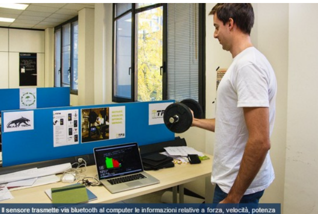
Il sensore trasmette via bluetooth al computer le informazioni relative a forza, velocità, potenza
