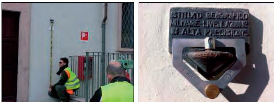
**Figura 5.** Livellazione eseguita nei pressi del chiusino in ghisa. A destra viene mostrato una *mensola* infissa sulla facciata con il corrispondente strumento che serve da supporto per l'effettuazione della misura
