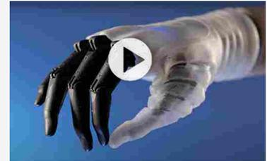
Mano robotica con motoriduttore MICROingranaggi per l'IIT
