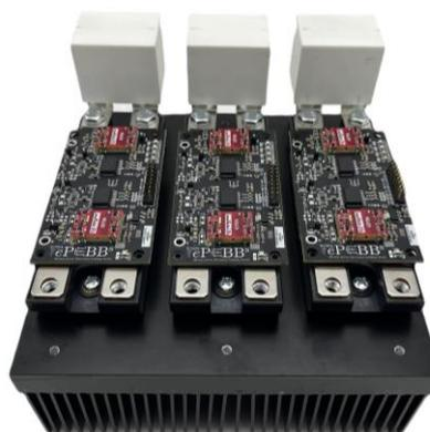
*Da sx. a dx: alcuni prodotti progettati e realizzati da ePEBBs (eWICH, sistema per la ricarica wireless di veicoli leggeri e droni, e eBRICK, sistema modulare per la conversione DC-DC nella ricarica bi-direzionale V2X di veicoli elettrici).*
